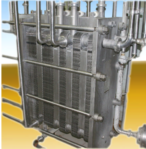
Resim 3.1: Plakalı ısı değıştirici (pastörizatör)
